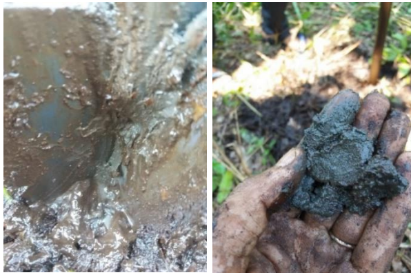
Gambar 19. Kedalaman 4 meter terdapat lapisan tanah mineral
