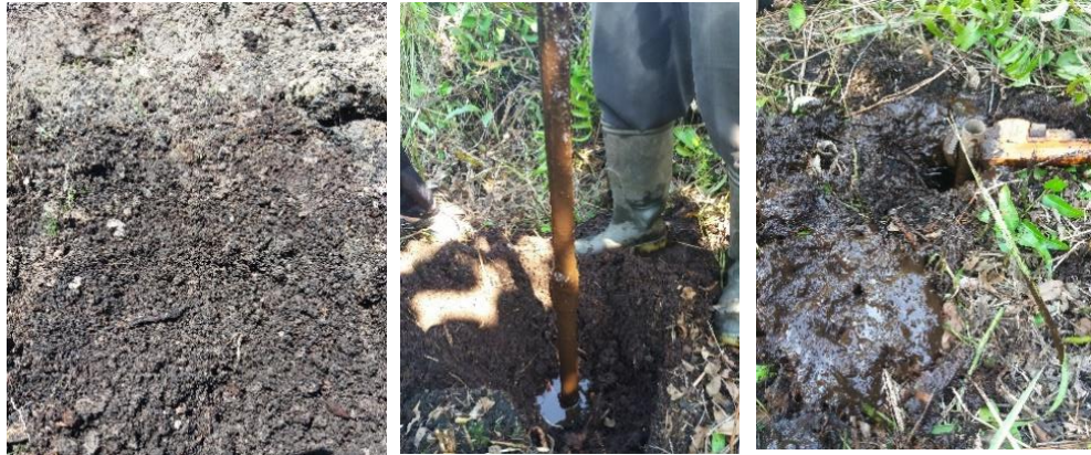
Gambar 50. Pengukuran kedalaman tanah gambut
