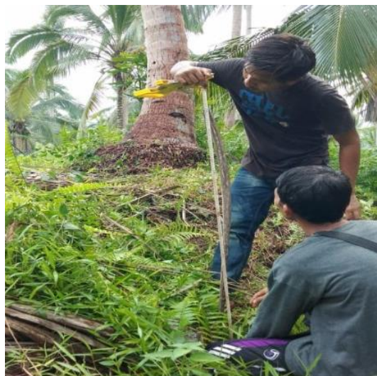
Gambar 13. Subsiden Gambut 1,2M di Parit Riau, Dusun Sepakat
