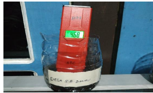
Pengukuran Sampel Gambut Menggunakan pH Meter
